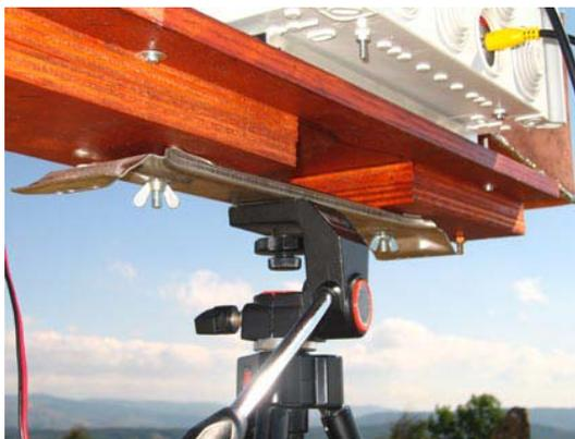
**Figure 2 Fixation au trépied photo**
