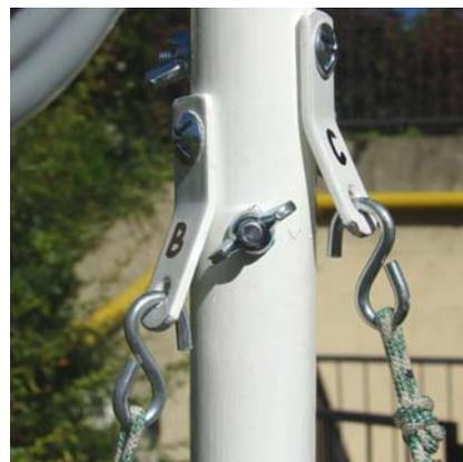
Le réglage final de la longueur de chaque sustenté se fera en refaisant le nœud d'arrêt plus ou moins loin, au niveau de l'enroulement sur les tubes formant le trépied.
