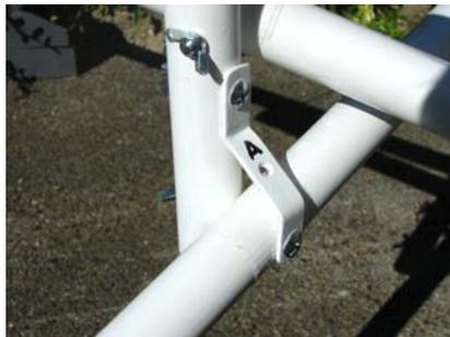
Fixer ensuite chaque sustente aux attaches correspondantes, le trépied doit tenir debout seul. Poser enfin le bloc moteur avec son boom horizontal au dessus, ce qui a pour effet d'alourdir l'ensemble et de tendre les drisses... Le trépied est en place en moins de 3 minutes !
